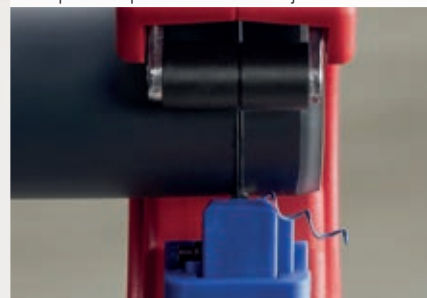
Podem ser cortados segmentos curtos de até 10 mm. O segmento em espiral tem origem na chanfragem.
